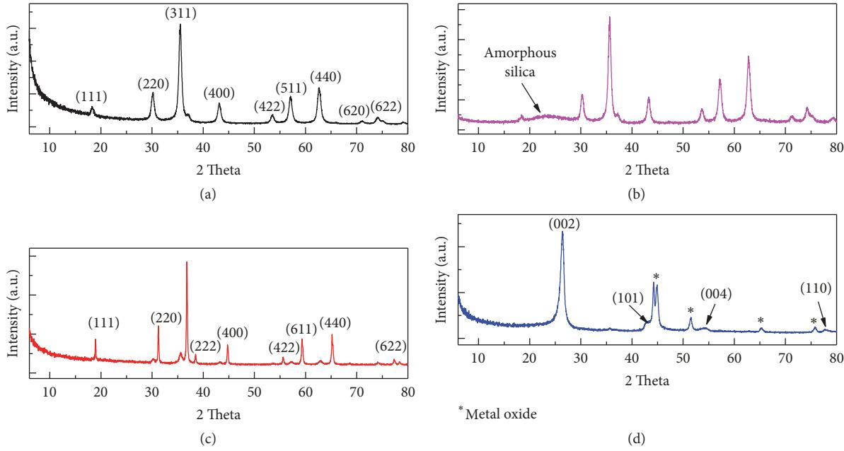
FIGURE 2: XRD pattern of  $\text{Fe}_3\text{O}_4$  (a),  $\text{Fe}_3\text{O}_4@\text{SiO}_2$  (b),  $\text{Fe}_3\text{O}_4@\text{SiO}_2\text{-Co}$  (c), and  $\text{Fe}_3\text{O}_4@\text{SiO}_2\text{-MWCNT}$  (d).
