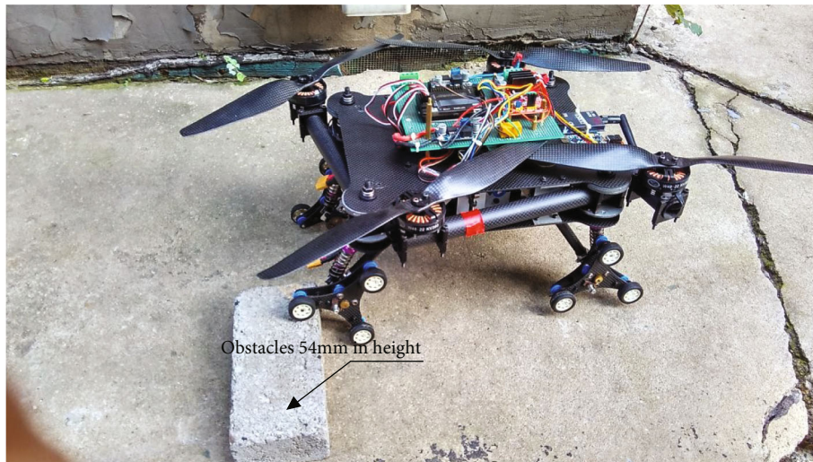
(d) Single planetary wheel climbs obstacle 2
