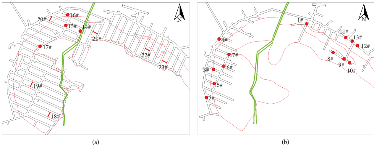
FIGURE 5: EDZ test position on the roof or sidewall. (a) -218 m sublevel. (b) -236 m sublevel.
