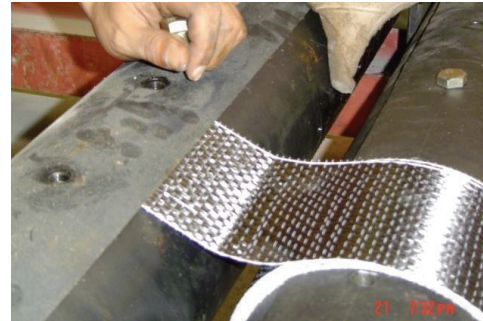
(d) Fixing the CFRP sheet using a clip
