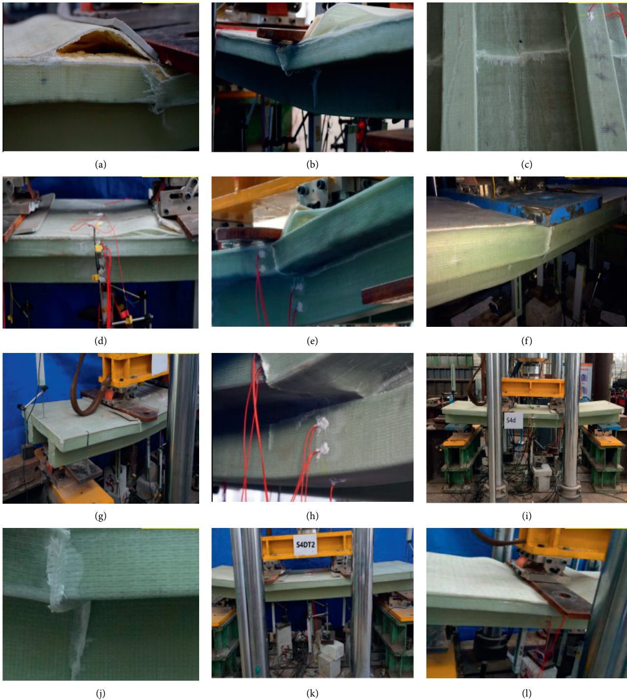
FIGURE 5: Failure modes. (a) S2D. (b) S4D. (c) S4D. (d) S6D. (e) S4DH. (f) S4DV. (g) S4DVH. (h) S4DV. (i) S4d. (j) S4d. (k) S4DT2. (l) S4DT3.
