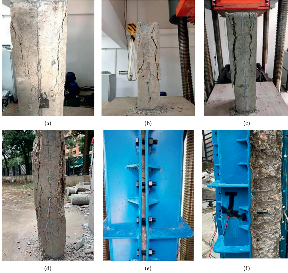
FIGURE 6: Failure modes of typical specimens. (a) CC-2. (b) RC0-1. (c) RC2-2. (d) RC3-1. (e) RC2-2. (f) RC3-1.
